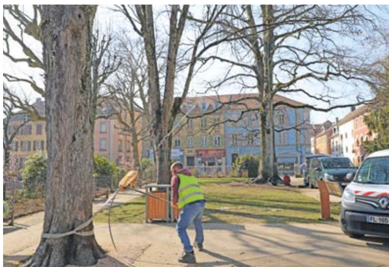
Une mise en tension pour vérifier l'état de santé du hêtre pourpre du square François-Géant le 24 mars
