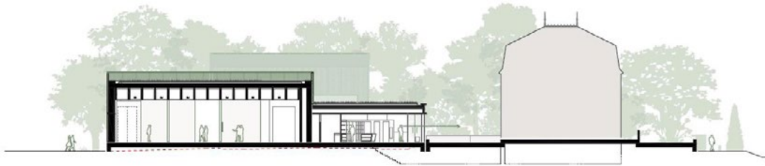
Coupe avec vue de la liaison enterrée
