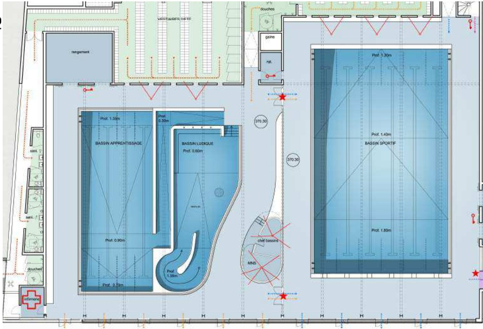
Les plans d'eau intérieurs sont constitués d'un bassin sportif de 6 couloirs de 25 mètres, soit 375 m<sup>2</sup> et d'un bassin de loisir et d'apprentissage de 300 m<sup>2</sup>
