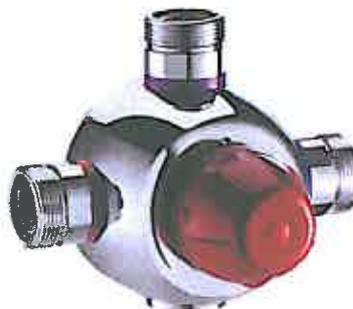
En sortie de chauffe eau, il sera prévu un mitigeur thermostatique, de marque DELABIE type PREMIX Securit, avec clapet anti-retour, filtres, réglable de 46 à 60°C, avec sécurité anti-brûlure, compris vanne d'arrêt d'équerre, à boisseau sphérique, chromé avec filtre et purge.
