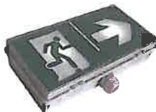
**BAES** Bloc autonome d'éclairage de sécurité de type PLANETE DESIGN 60D de LUMINOX ou techniquement et esthétiquement équivalent. A chaque fois que cela est possible, ces blocs seront encastrés dans le faux-plafond à l'aide d'un cadre d'encastrement LUM 105 14 de chez LUMINOX
